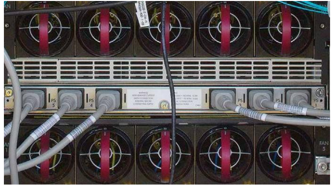
配置多個電源輸入的一般伺服器由 2 個 ePDU 供電
