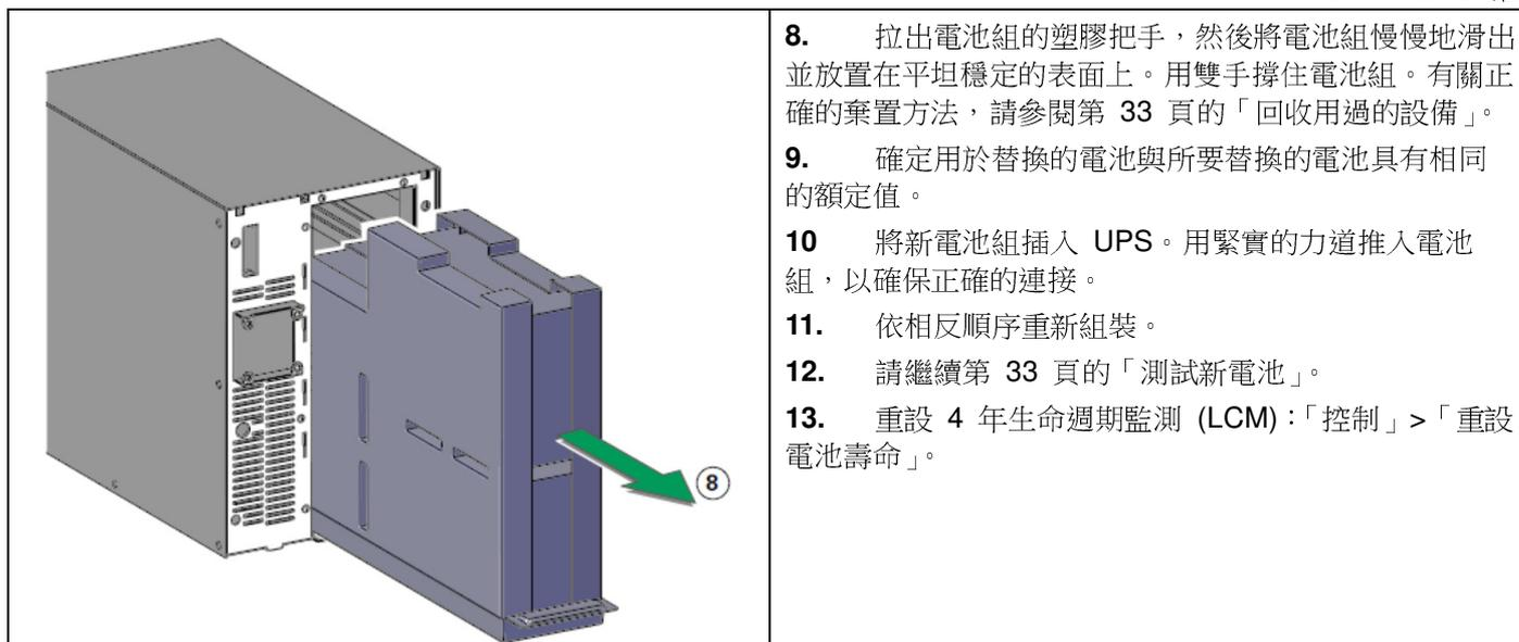
8. 拉出電池組的塑膠把手，然後將電池組慢慢地滑出並放置在平坦穩定的表面上。用雙手撐住電池組。有關正確的棄置方法，請參閱第 33 頁的「回收用過的設備」。
