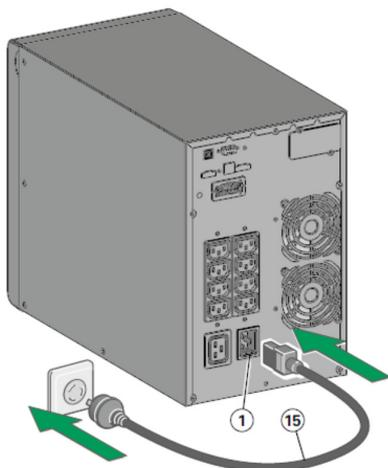
1. 將 UPS 輸入電源線 ① 連接至 AC 電源。(機型 **9SX1000G/9SX1500G/9SX2000G/9SX3000G/9SX3000GL** 除外)。
