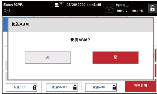
圖6-33：使能高級電池管理(ABM) 指令確認螢幕
