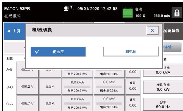
圖6-16：選擇電壓顯示模式螢幕
