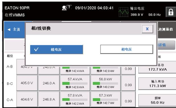
圖6-12：選擇電壓顯示模式螢幕
