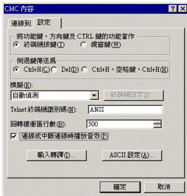
6. 在隨後打開的對話方塊中作如下圖所示的設定，於行列延遲設為 1000 毫秒，然後一直選擇確定退出到步驟 4 主畫面。
